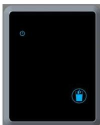
La distribution de glace s'arrêtera à la fin de la durée configurée par l'installateur lors de la première mise en service ; l'eau sera distribuée de façon continue jusqu'à ce que la touche soit relâchée.
